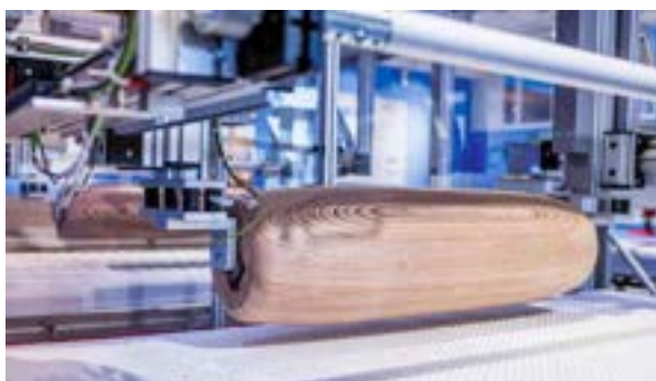
Testovanie mechanickej odolnosti. Simulácia životnosti matraca maximálnym zaťažením v najexponovanejšej časti matraca valcovaním.
